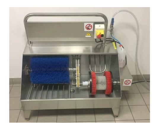
Stazione per **pulizia** di **suole** calzature compreso **tomaia** e **gambale** con 2 spazzole di conformazione diversa facilmente estraibili per pulizia con idropulitrice.
