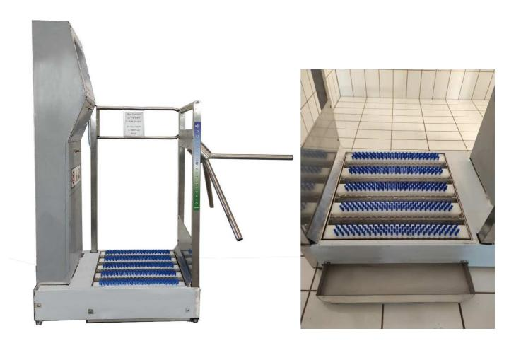
Corridoio di igienizzazione **statico** Pulitak cm 60x60 in acciaio inox AISI 304 provvisto di spazzole in nylon fisse predisposto per la pulizia **a secco** - munito di ugelli per la nebulizzazione del disinfettante sulle suole comandata dal nebulizzatore mani 837 C- corredato di cancello pneumatico.
