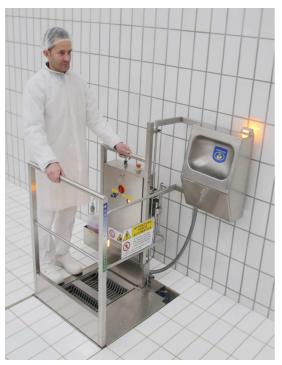
ERTIK, grazie alla struttura ad incasso, risulta totalmente in linea con il pavimento senza scomodi scalini che possano rendere difficoltoso il passaggio. Per la pulizia della suola la macchina dispone del sistema di pulizia a 5 spazzole che consente di pulire anche la tomaia permettendo l'igienizzazione dell'intera calzatura.
