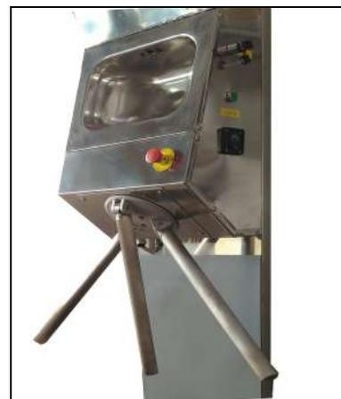
Stazione di accesso con controllo della nebulizzazione di detergente e/o disinfettante sulle mani dell'operatore abbinato a stazione igiene 926 AU2 munita n° 2 spazzole e di n.°2 ugelli per la nebulizzazione del disinfettante per la pulizia suole con predisposizione serpentino acqua.
